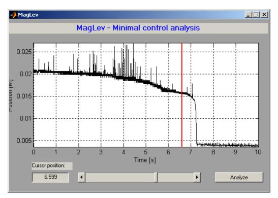
Fig. 21. The sphere motion
