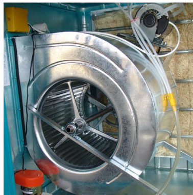
شکل ۱: نمای داخل یک کولر آبی
